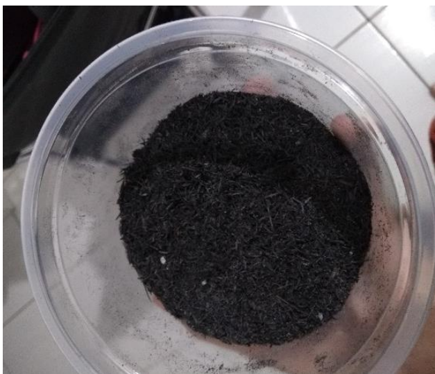
Figura 1. Fuligem obtida a partir de processo de incineração da cana-de-açúcar em forno mufla.
